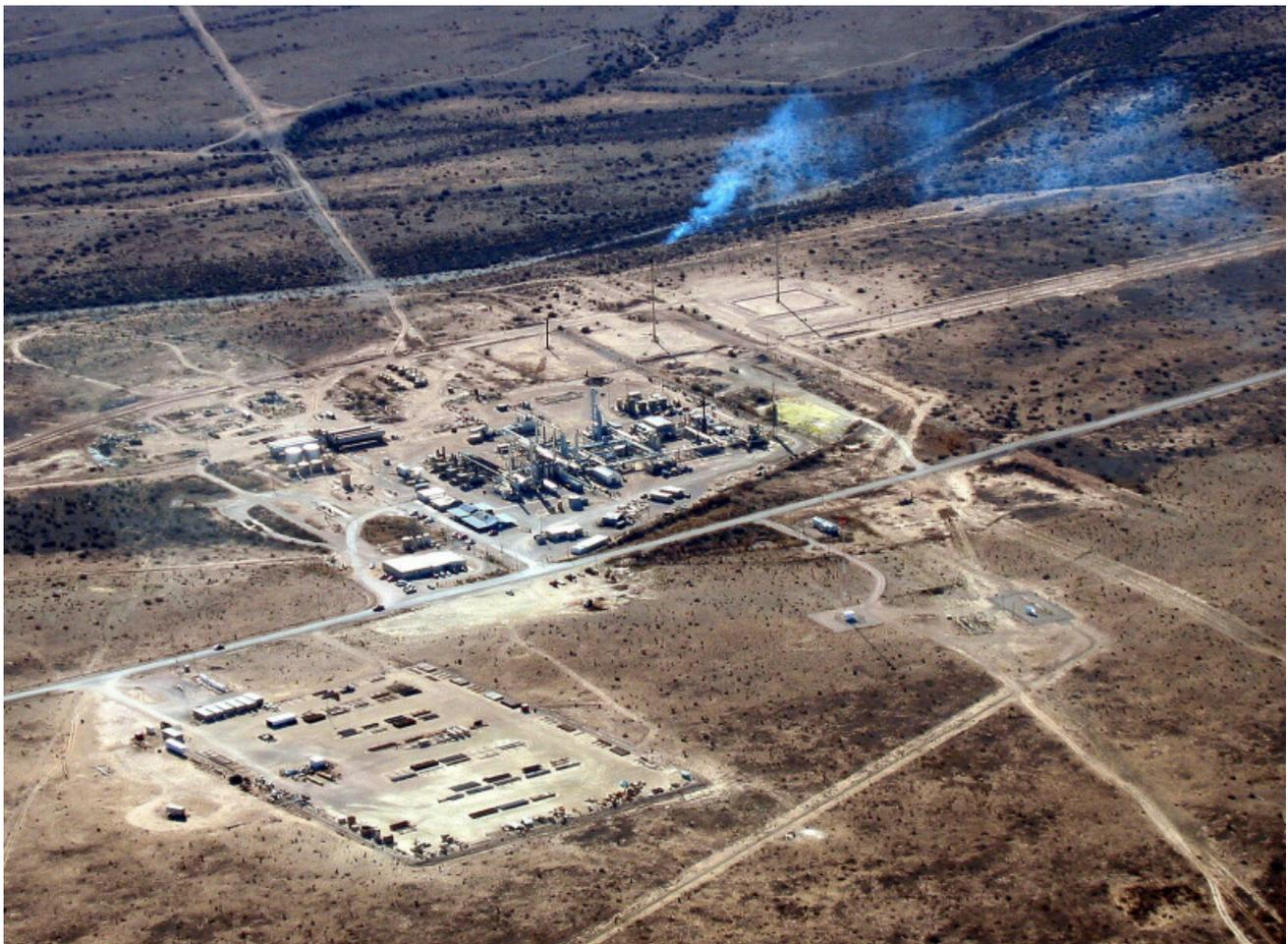
La photographie date de 2003, avant le boom du gaz et du pétrole de schiste, mais elle montre le principe du brûlage (ou torchage) des gaz non désirés. On voit aussi un tas de soufre (la tache jaune au centre de la photographie), qui est un sous-produit du procédé industriel de la production de gaz naturel. Photographie de SkyTruth, 2003, licence CC ([source](#)).
